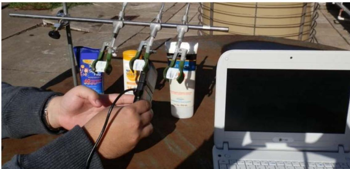
Figura 3. Montaje del dispositivo experimental al aire libre. En cada una de las pinzas se coloca un cubre-objeto con protector ubicado directamente hacia el Sol. El estudiante con los sensores de radiación UV mide la irradiancia en cada caso. Las lecturas se obtienen en el ordenador a través del programa Neulog.
