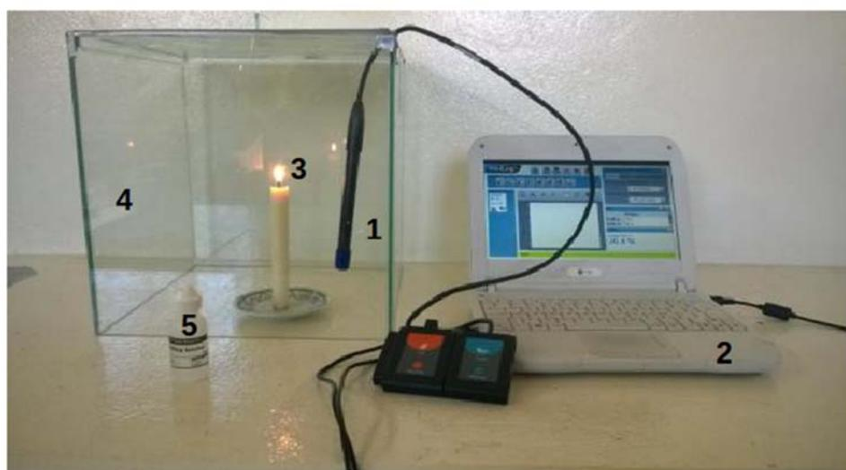
Figura 1. Montaje experimental: 1-sensor de nivel de oxígeno, 2- ordenador o PC, 3- vela, 4-recinto cerrado y 5-solución de referencia del sensor.
