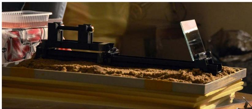
Así como la coherencia es necesaria, deben considerarse la distancia de la fuente hasta la placa fotográfica holográfica, minuciosos tiempos de exposición de las placas a la luz, potencia y estabilidad eléctrica y lumínica de la fuente laser.
