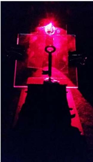
La placa recibe la luz laser roja directamente por el frente y el reflejo de la que impacta con el objeto (llave) por detrás. Sobre la placa se produce la interferencia de ambos rayos, lo que produce el registro. Se trata de una holografía por media de la técnica de reflexión.
