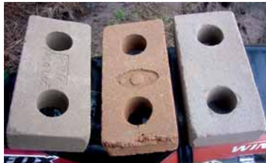
Pedro, ladrillero que participó de los talleres y por iniciativa propia construyó una bloquera adaptada a sus necesidades. Muestra de los bloques de tierra comprimida fabricados por él.
